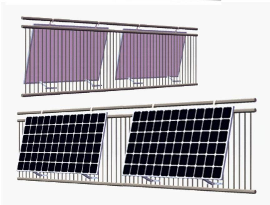
Fissare tramite bulloni le staffe ad U e le barre di alluminio al telaio del modulo su fori già predisposti
