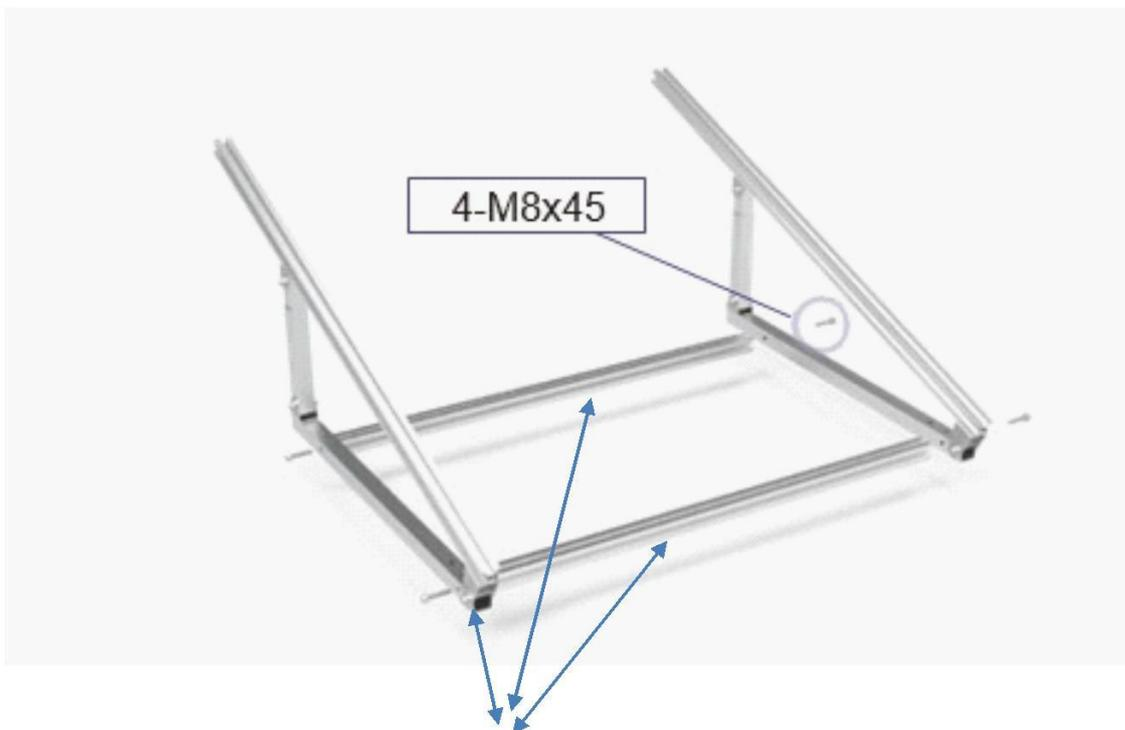
Installare i pilastri e fissarli con i bulloni in dotazione
