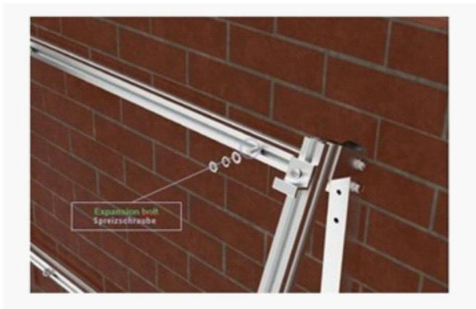
Installare la struttura universale con idoneo sistema di fissaggio in base alla consistenza e tipologia della parete e della zona climatica ed altezza di installazione.
