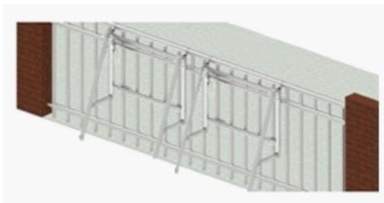
Abbinare alla struttura universale sopra indicata le staffe ad U, avvitandole con appositi bulloni alla parte superiore dei montanti in modo da poter fissare la struttura alla barra superiore della ringhiera, inserire quindi la vite di sicurezza al fine che la staffa ad U non possa sfilarsi dal montante della ringhiera.
