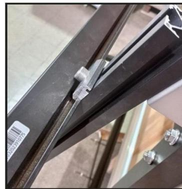
martelletti per fissaggio Pannello a struttura (n. 4 pezzi)
