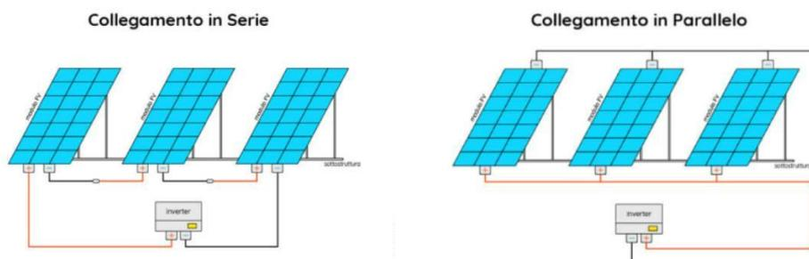
Per quanto sopra, nel nostro caso, si può dedurre che per il sistema da 350W si può utilizzare un solo modulo, mentre per il sistema da 700W si possono utilizzare al massimo due moduli da 350W collegati in parallelo.
