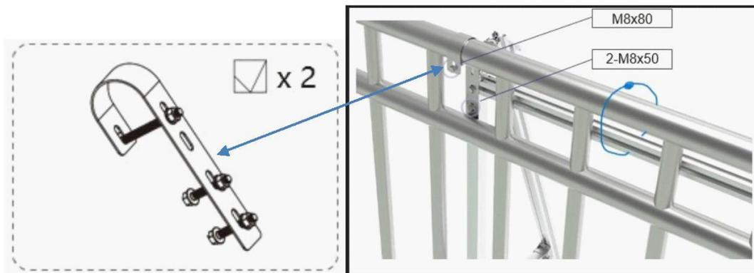
Su questo tipo di installazione si consiglia di predisporre fune di sicurezza, presente nel KIT, da agganciare fra parapetto o ringhiera, struttura del supporto Plug and Play, e modulo, con adeguata capacità portante (questo va fatto su tutti e due i telai).
